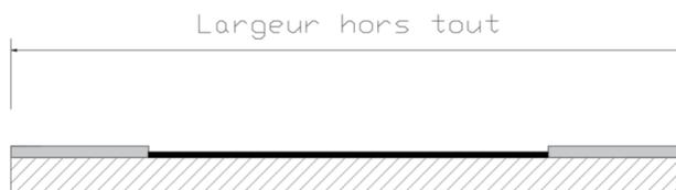
Lorsque l'ouvrage est recouvert d'un remblai, renseigner **la largeur hors tout** même en présence de dispositifs de retenue (sans prendre en compte les sifflets dans le cas des buses métalliques)
